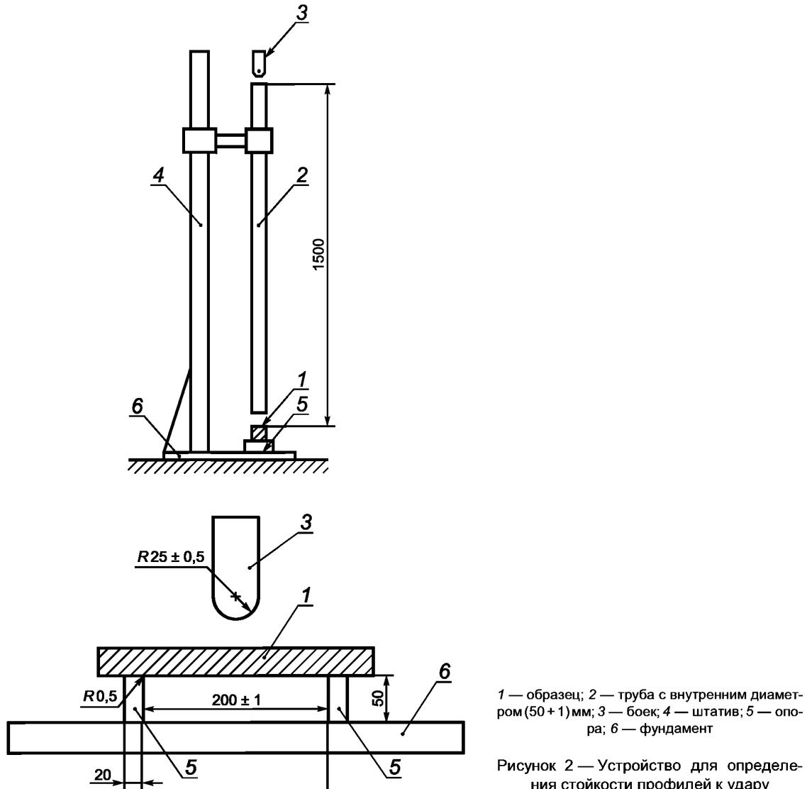
Рисунок 2 — Устройство для определения стойкости профилей к удару
